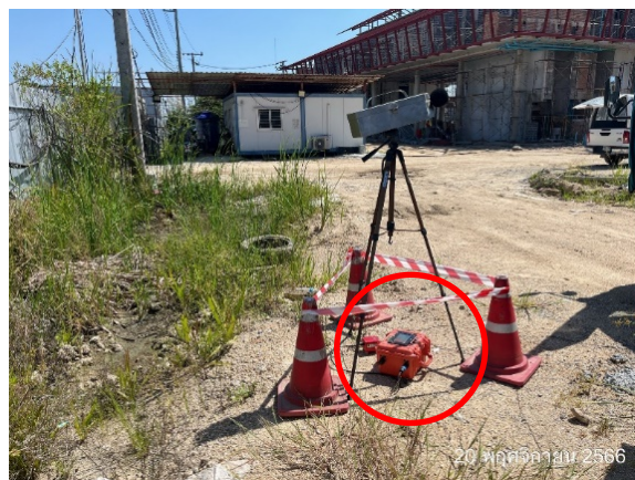
ภาพที่ 3.5.5-1 แสดงการตรวจวัดความสั่นสะเทือน
